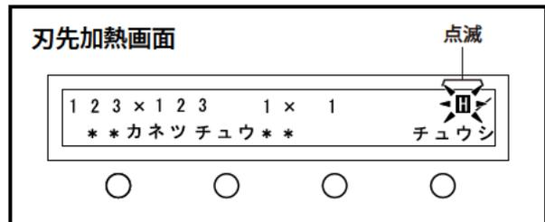
6 刃先加熱が完了すると右側に『H』マークが点滅から点灯に変わります。『H』マークを確認後、『スタート』ボタンを押します。
